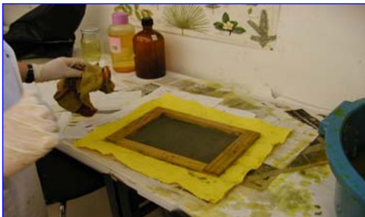
Fig. III.25. Extrayendo el agua de la lámina de papel (en el tamiz) con la ayuda de un trapo seco.
