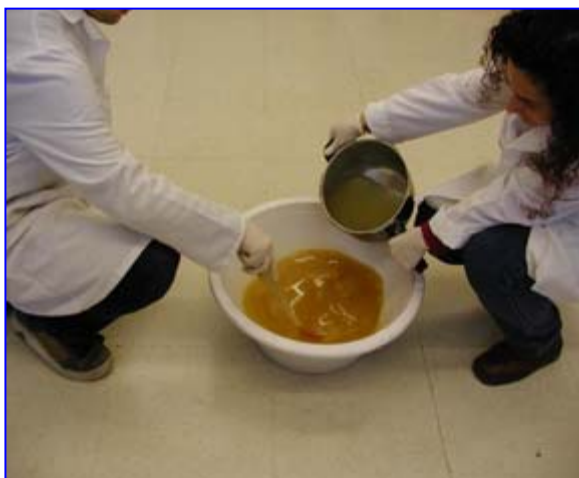
Fig. III.5. Mezclando la solución de sosa y agua en el aceite.
