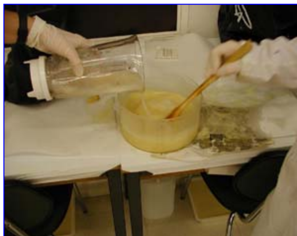
Fig. III.5. Mezclando la solución de sosa y agua en el aceite.
